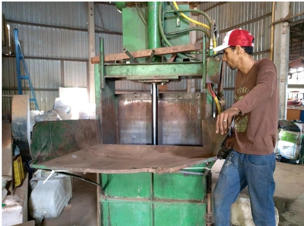
Figura 12: prensa utilizada para processar o material reciclável separado, cedida pela empresa parceira (operador autorizou a fotografia e sua publicação - pedido verbal).
